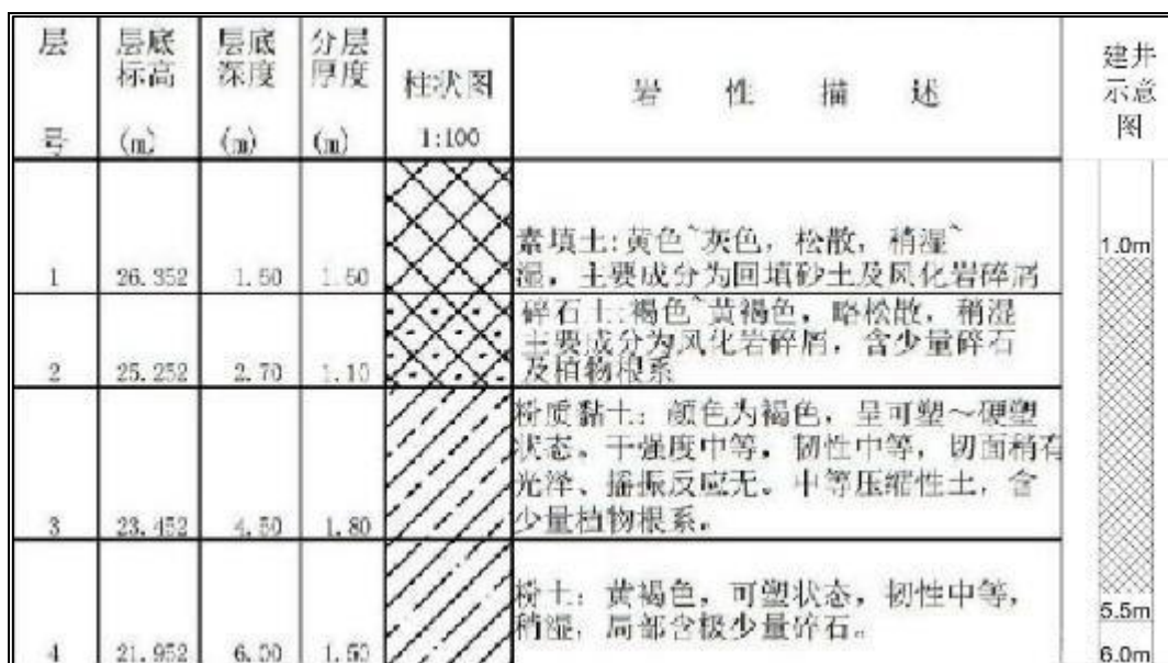
图 6-6 钻孔柱状图及对应的建井示意图
